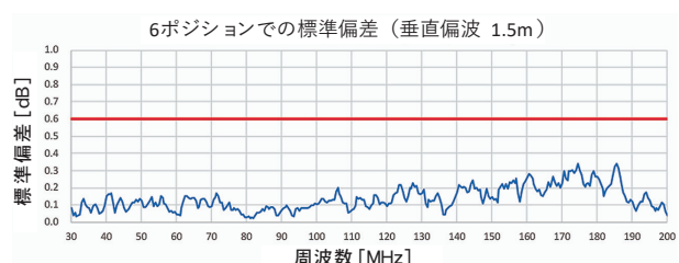
図10 基準オープンサイトA 垂直偏波の測定結果
