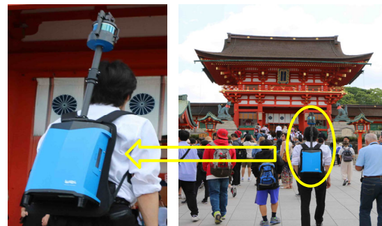
バックパック型ライダーを用いた測定風景
