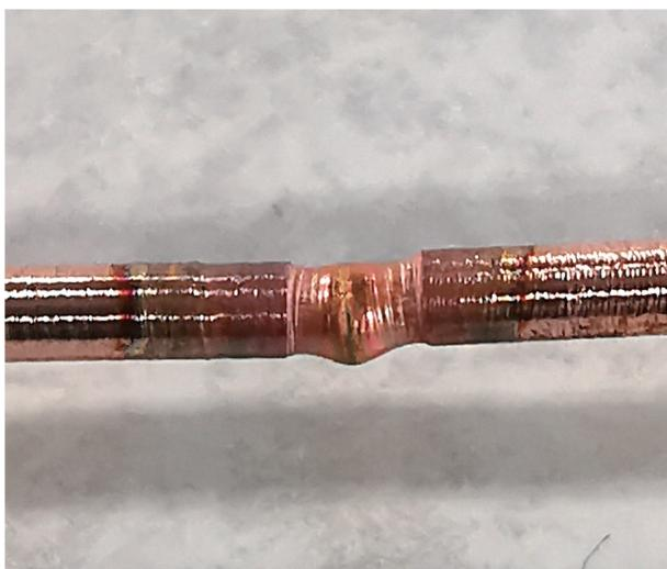
図3 Φ1.8mm純銅単線の溶接例
