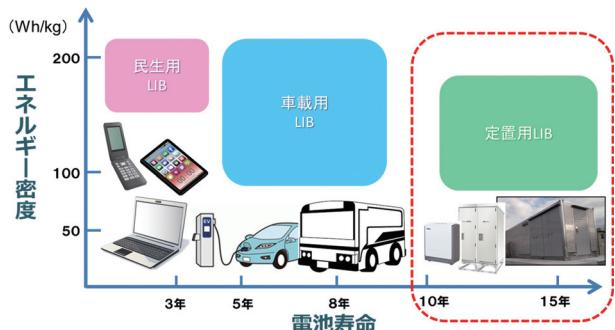
図6 各用途におけるリチウム二次電池の期待性能比較
