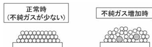
図4 薄膜形成のイメージ
