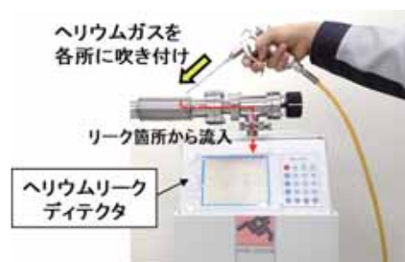
図11 ヘリウムリークテストの様子
