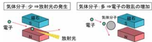
図3 気体分子の量に応じた電子の挙動の違い
