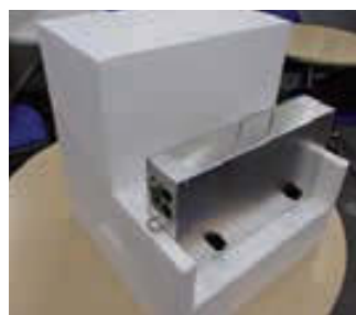
放射エミッション測定 (30 MHz-1000 MHz)
