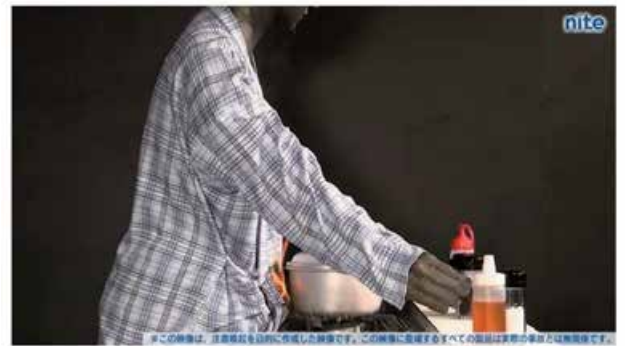
図5 ガスこんろの炎に衣服が接触して着火(再現映像内) [4]
