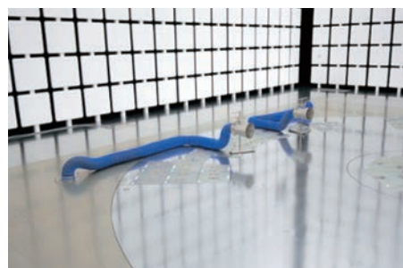
排気ガスダクト
